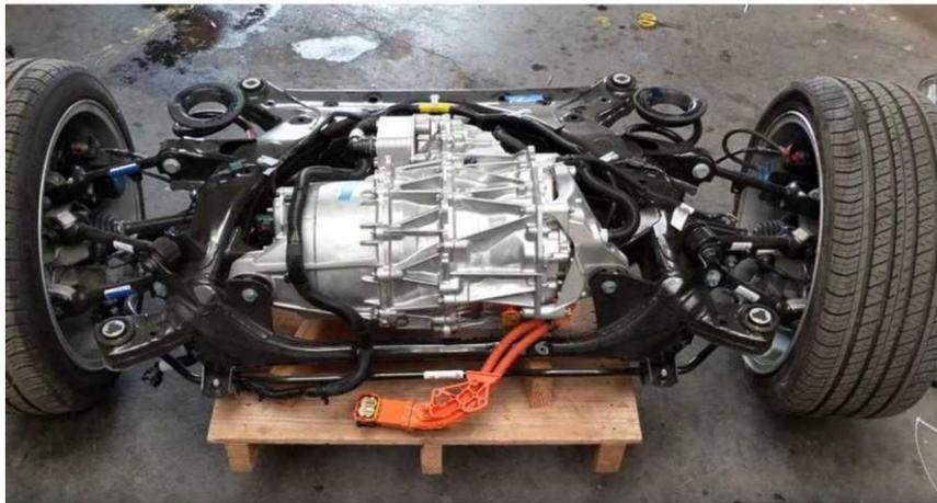
Un motore elettrico ha una efficienza (il rapporto tra quanta energia assorbe e quanta viene trasformata effettivamente in movimento) molto elevata, superiore al 90%; i motori più raffinati, come quelli più recenti di Tesla, superano il 96%. Per confronto, un motore endotermico di eccellenza (ad esempio quelli attuali di formula 1) può arrivare al 50%, ma i motori di tutti i giorni si fermano attorno al 30%, il resto dell'energia presente nel carburante viene persa sotto forma di calore.
