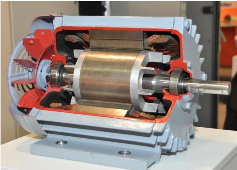
A differenza di un motore endotermico, la coppia che produce è abbastanza costante al variare dei giri ed è presente anche da fermo, per questo motivo non necessita di cambio e frizione.
